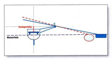
Abbildung 4: Steilere Lage des Ruders bei Verkürzung des Außenhebels und gleichbleibender Auslegerhöhe (Schema).
